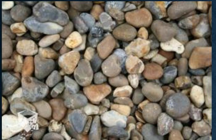
• شن و ماسه مصرفی در بتن به دو صورت مورد استفاده قرار می گیرد. یکی صالح سنگی طبیعی که از بستر رودخانه ها یا معادن شن و ماسه به دست می آید و با کمک سرند و تسمه نقاله از یکدیگر جدا شده و مورد مصرف قرار می گیرند. این نوع شن و ماسه به صورت گرد گوش و کروی شکل است.
